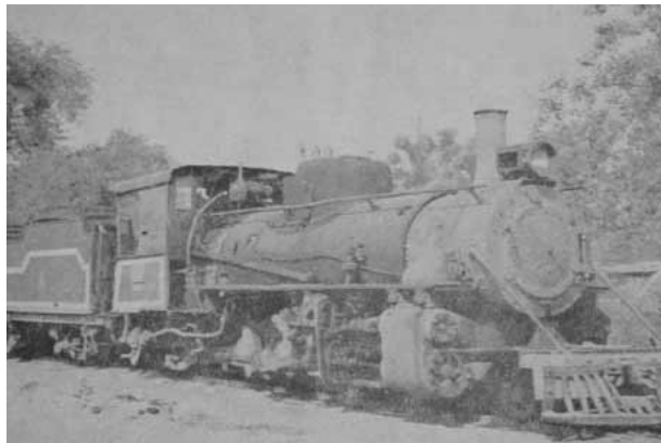
写真24 インド国鉄に最後に納入された狭軌610mm蒸気機関車、No.NH-5、814、1959、日本車輛製 (「locomotives in steam」、RR Bhandari著より)
